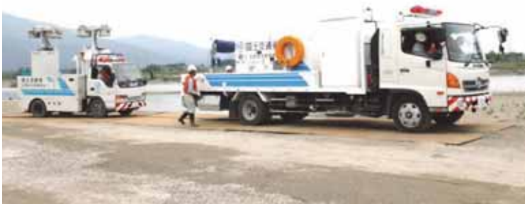
排水ポンプ車・照明車
