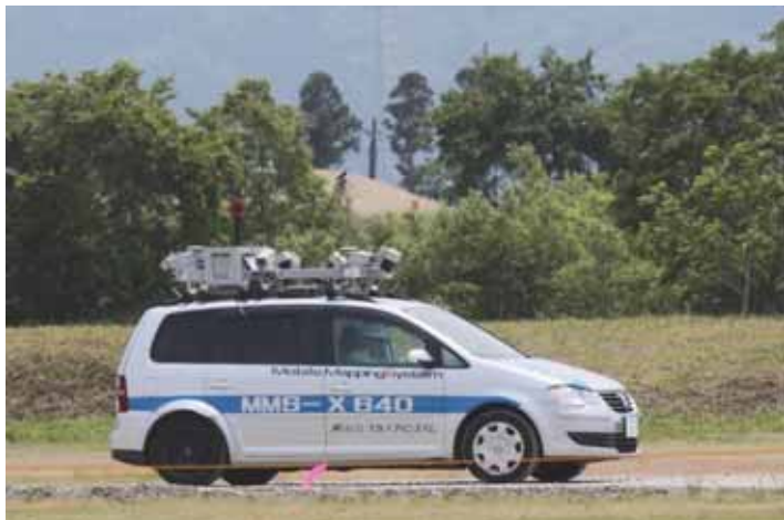
三次元レーザなどを活用した移動計測
