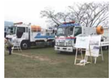
北陸技術事務所 排水ポンプ車(左) 関東地方整備局 排水ポンプ車(右)
