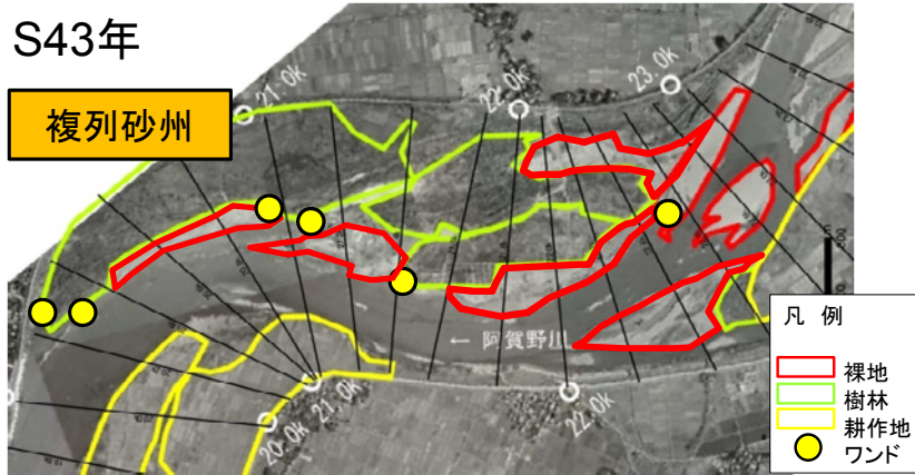
参考図1 複列砂州化し、河原が維持されていた昭和40年頃の水ヶ曽根地区
