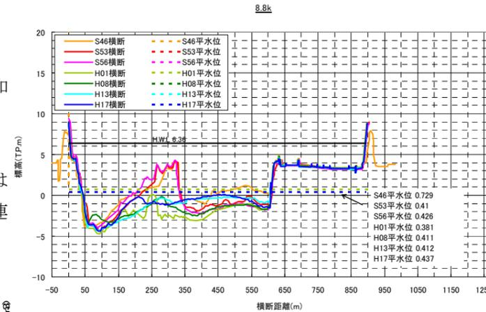
図 3.1-2 下流部 2 での横断面の変化 (8.8k)
