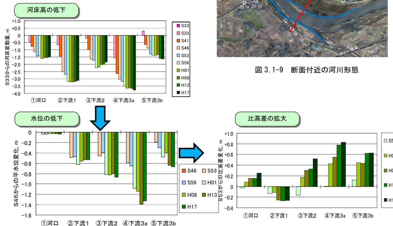
図 3.1-10 河床高・水位・比高差の変化
