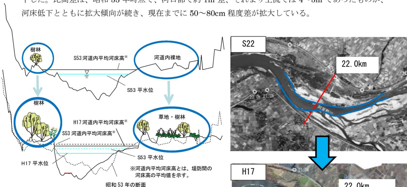
図 3.1-8 河床が低下し、水位が低下した断面
