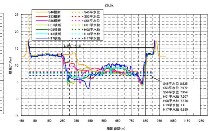
図 3.1-3 下流部 3 a での横断面の変化 (26.6k)
