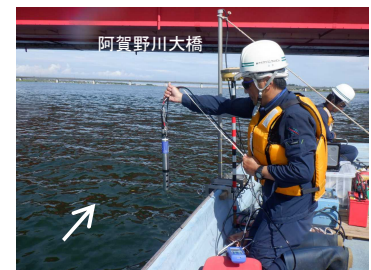
調査状況 調査方法 ・塩分濃度計により水中の塩分濃度を計測
