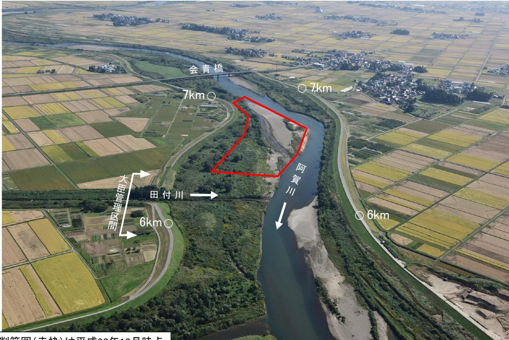
※掘削範囲(赤枠)は平成28年10月時点の航空写真を基に概ねの範囲を示したものであり、その後の出水等により砂州形状等が変化しているため、実際の掘削範囲は異なる場合がある。
