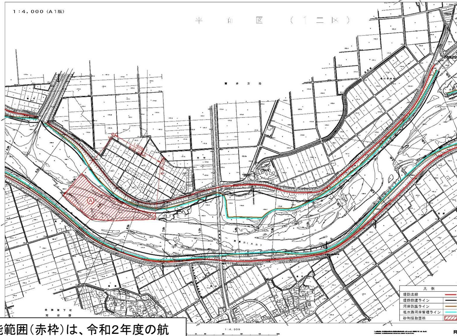
※掘削可能範囲(赤枠)は、令和2年度の航空測量成果より図示したものであり、出水等により砂州の形状が変化するため、実際の掘削範囲と異なる場合がある。
