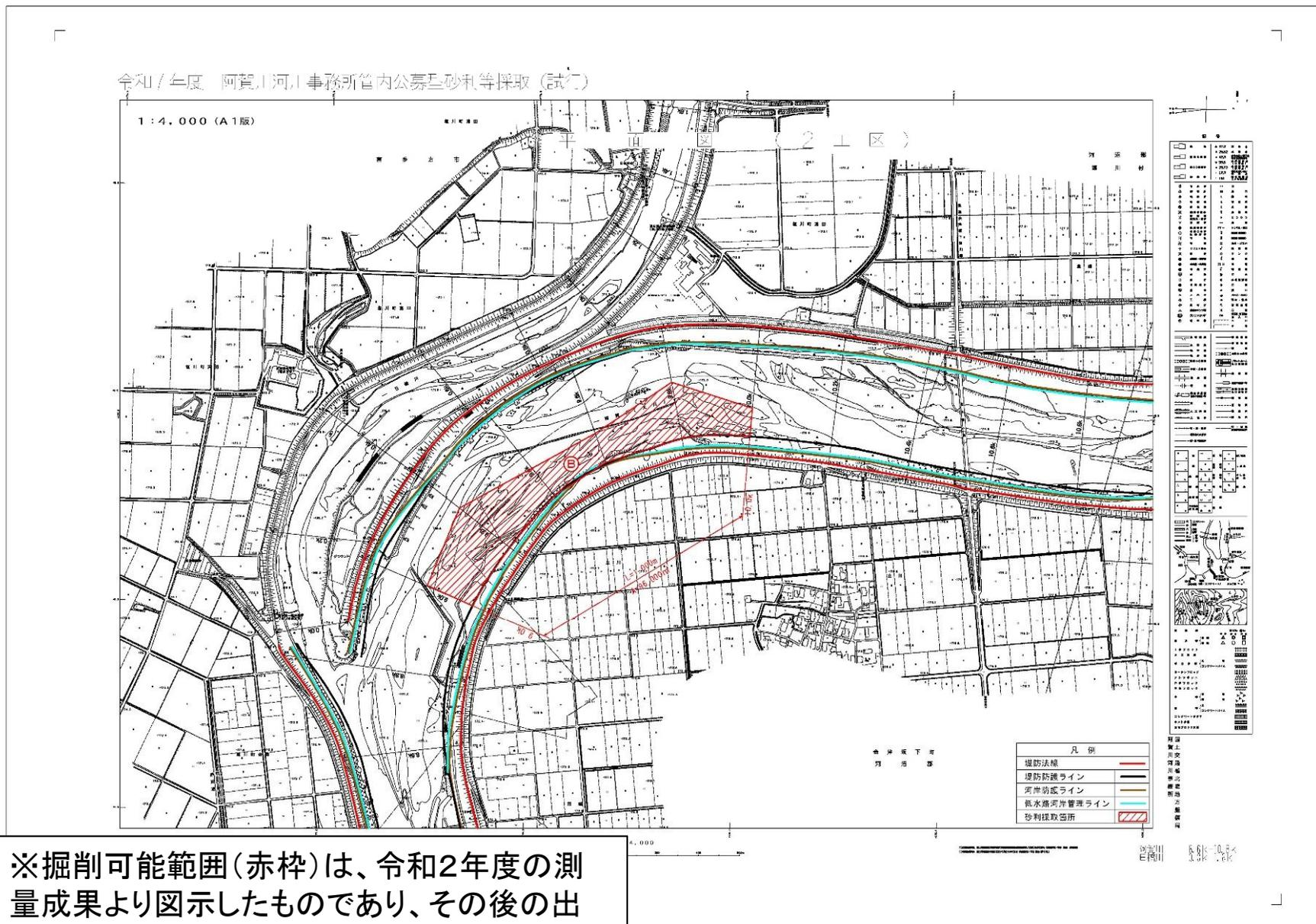
※掘削可能範囲(赤枠)は、令和2年度の測量成果より図示したものであり、その後の出水等により砂州形状が変化しているため、実際の掘削範囲と異なる可能性がある。
