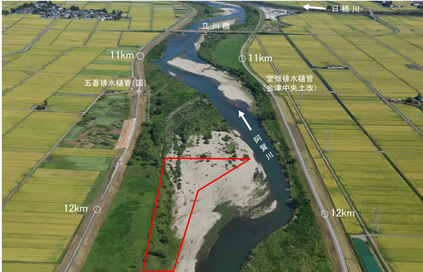
※掘削範囲(赤枠)は平成28年9月時点の航空写真を基に概ねの範囲を示したものであり、その後の出水等により砂州形状等が変化しているため、実際の掘削範囲は異なる場合がある。
