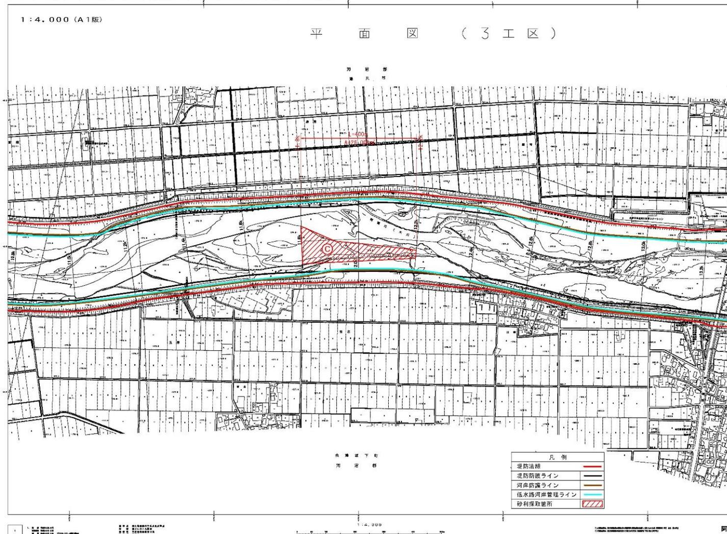
※掘削可能範囲(赤枠)は、令和2年度の測量成果より図示したものであり、その後の出水等により砂州形状が変化しているため、実際の掘削範囲と異なる可能性がある。
