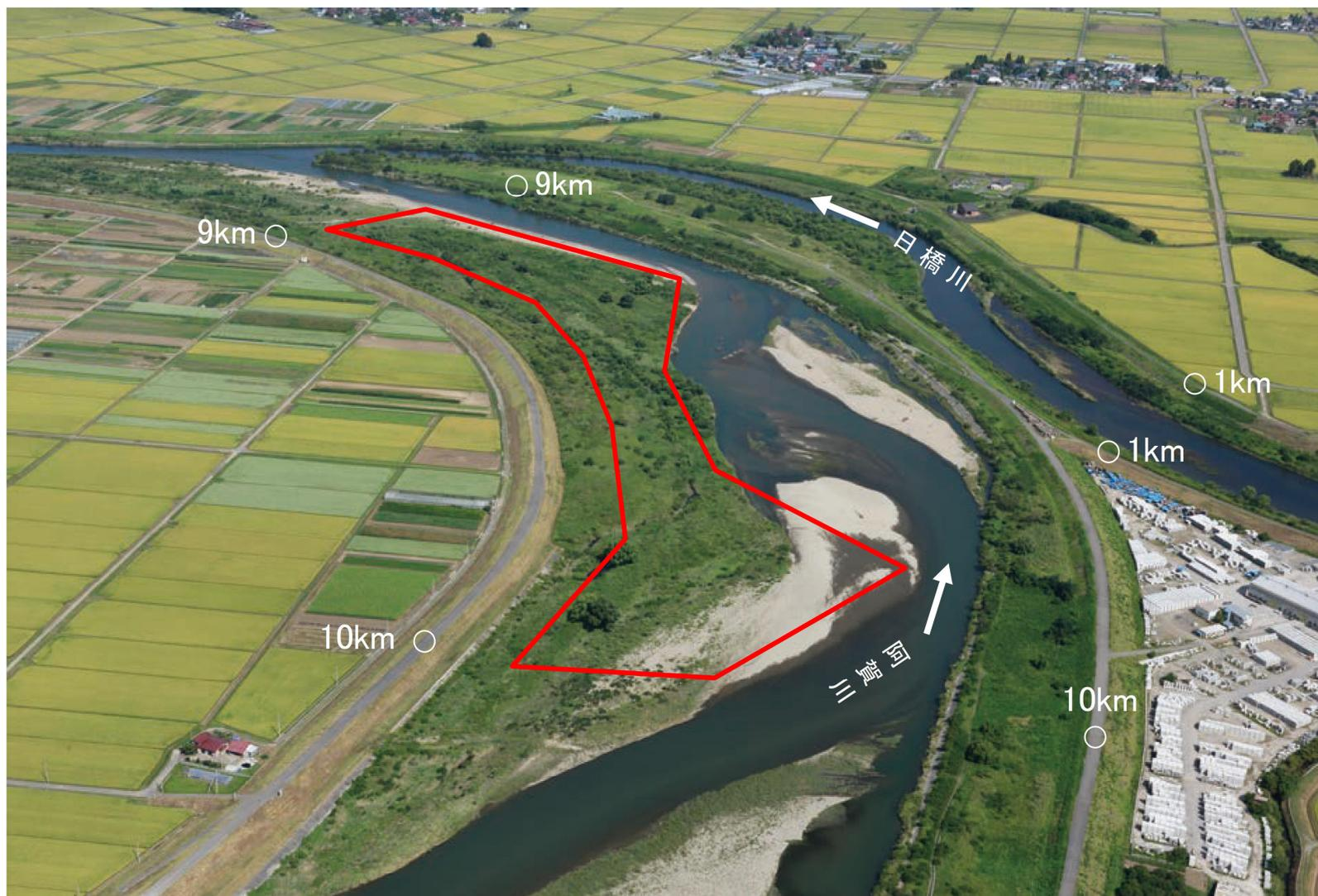
※掘削範囲(赤枠)は平成28年9月時点の航空写真を基に概ねの範囲を示したものであり、その後の出水等により砂州形状等が変化しているため、実際の掘削範囲は異なる場合がある。
