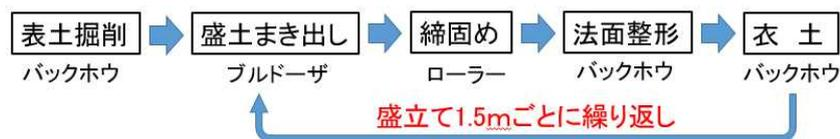
図-6 拡幅盛土の施工手順
