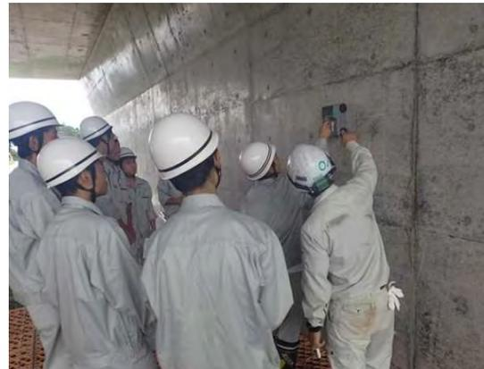
コンクリート構造物の非破壊試験
